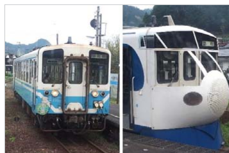
左は「鉄道ホビートレイン」に改造される前のレールバス。先頭部に右の団子鼻の構造物をくっつけて、「新幹線」の出来上がり!
