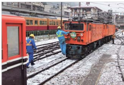
樽平から宇奈月へ戻ってくると、機関車はすぐ切り離されます。作業員の方と比べると、線路の幅や車両が小さいことが分かります。
