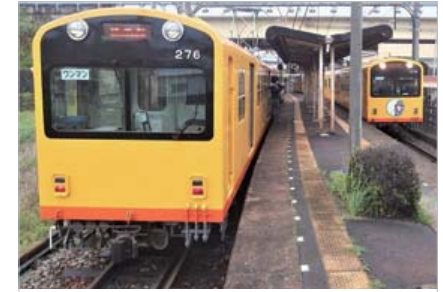
北勢線は、ナローゲージという幅の狭い線路を小型の電車が走ります。ホームの点字ブロックと線路の間隔を見比べると、その狭さが実感できます。
