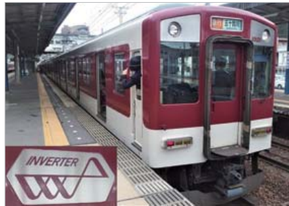
榛原から乗った急行の後ろ2両は日本初のインバータ制御の電車。インバータ車であることを示すプレートが誇らしげに取り付けられています。
