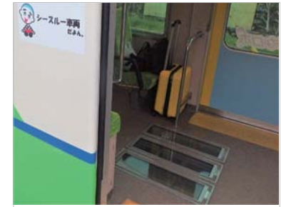
四日市あすなろう鉄道のシースルー車両。車輪の上の床がガラス張りになっていて、走行中に線路を見ることがユニークな車両です。
