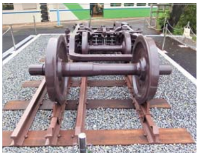
日永駅のホームにある線路の幅の比較。一番外側のレールが標準軌（新幹線など）、手前に車輪が載っているのが狭軌（JRの在来線など）、中央と右端のレールの間隔が四日市あすなろう鉄道や三岐鉄道北勢線のナローゲージ（762mm）です。
