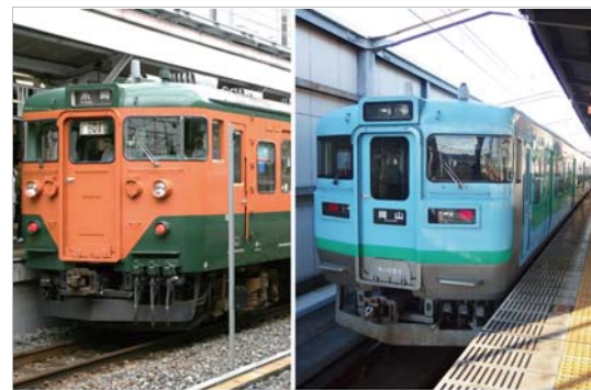
四国と本州を結ぶのに永らく使われたJR四国の電車(右)。左の国鉄時代に作られた電車をJR東日本から購入し、多度津の工場で大改造して見事に変身させましたが、今年の3月で引退予定です。
