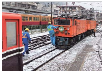
樺平から宇奈月へ戻ってくると、機関車はすぐ切り離されます。作業員の方と比べると、線路の幅や車両が小さいことが分かります。
